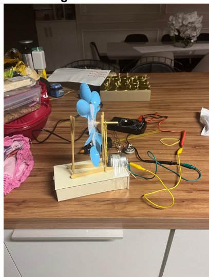
Figura 01. Estrutura do microgerador hidráulico construído com materiais recicláveis
