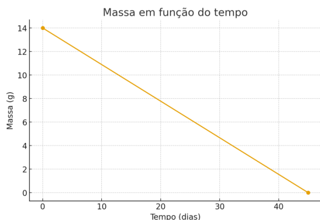
Figura 6: Gráfico da perda de massa (g) em função do tempo (dias) do bioplástico em solo natural
