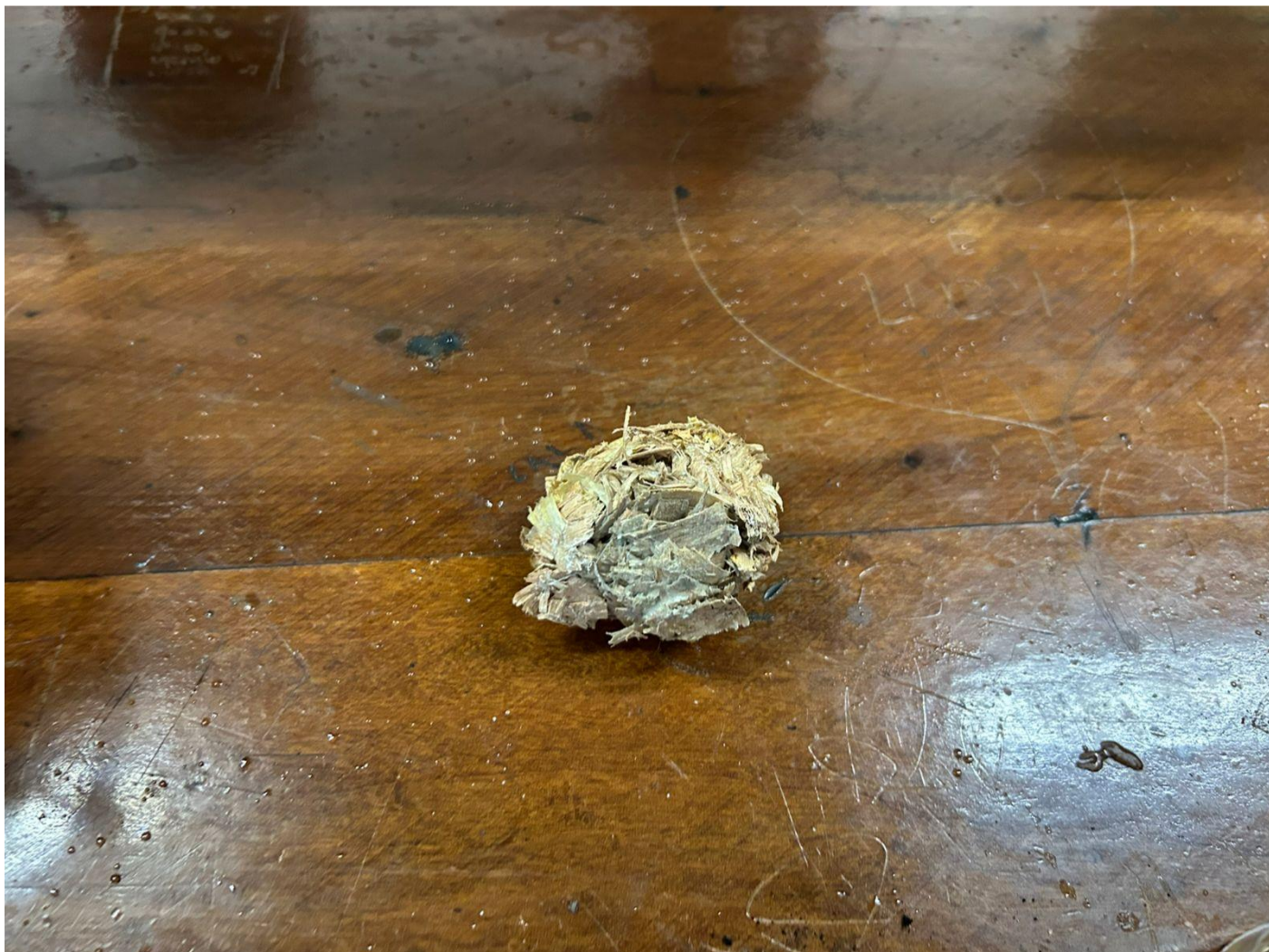
Figura 1: Briquete de serragem antes da queima.
