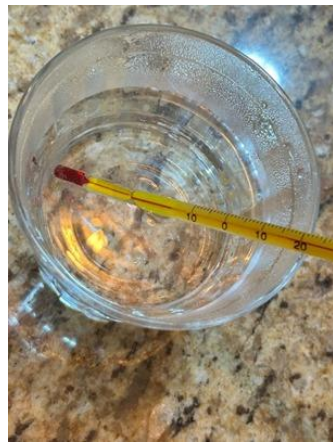
Figura 4: Termomômetro com a camada de óleo mineral.
