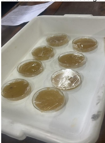
Figura — Placas de Petri logo após a coleta dos microrganismos, antes de serem colocadas na estufa. A imagem mostra o momento inicial do experimento, com todas as placas preparadas e identificadas para início da incubação.
