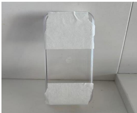
Figura 2 – placa de plástico com fita crepe, ferramenta utilizada para medir o escorrimento
