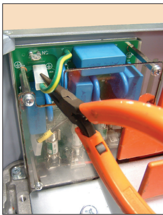
(b) Procedimento para desconexão do capacitor do filtro RFI e do varistor ligados ao terra – necessário para usar inversor com redes IT ou delta aterrado
