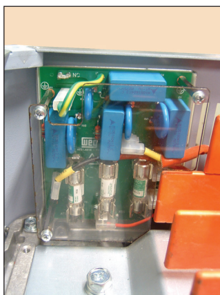
(b) Procedimento para desconexão do capacitor do filtro RFI e do varistor ligados ao terra – necessário para usar inversor com redes IT ou delta aterrado
