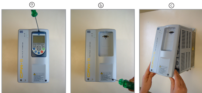
Figura 2 - Remoção da tampa frontal
