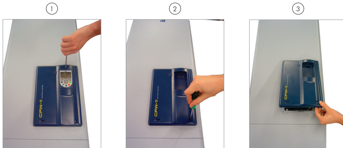
Figura 3.3 - Remoção da HMI e da tampa do rack de controle
