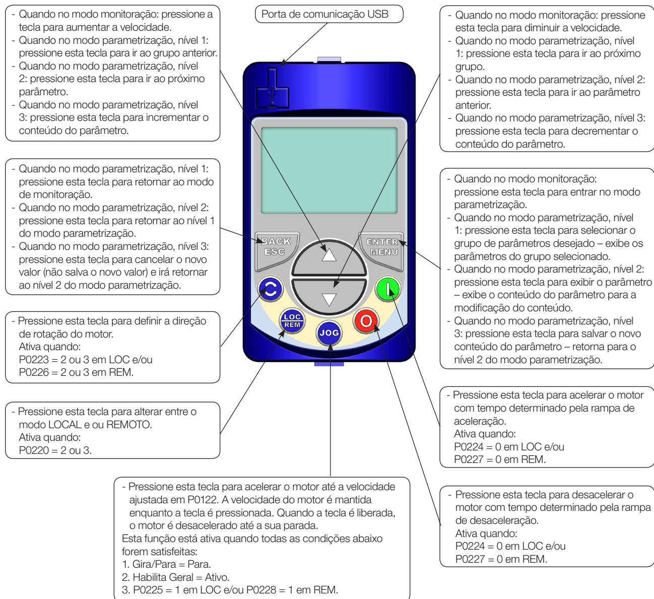
Figura 4.1: Teclas da HMI
