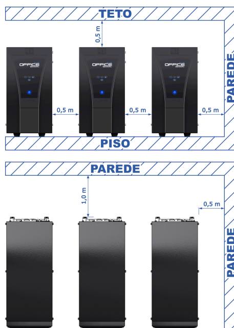
Figura 5.2: Layout de instalação
