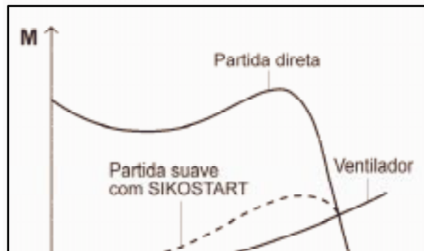
Figura 2.5 Ajuste correto dos parâmetros de partida
